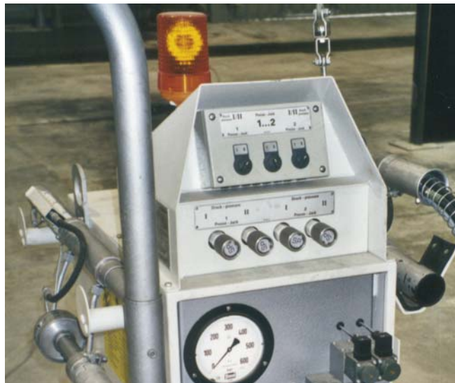
Comando especial para pré-selecção de várias pressões de tensado
