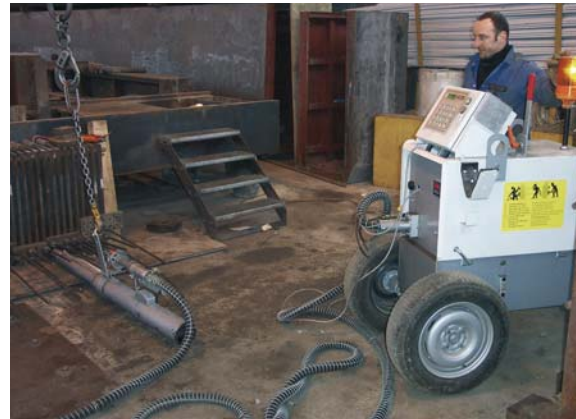
Macaco de tensar 300 kN/curso 400 mm dispendo de unidade TensaControl para o pré-esforço de cordão de 0.6"
