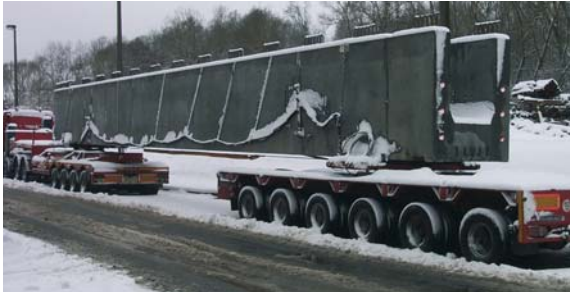
Viga de ponte durante o transporte
