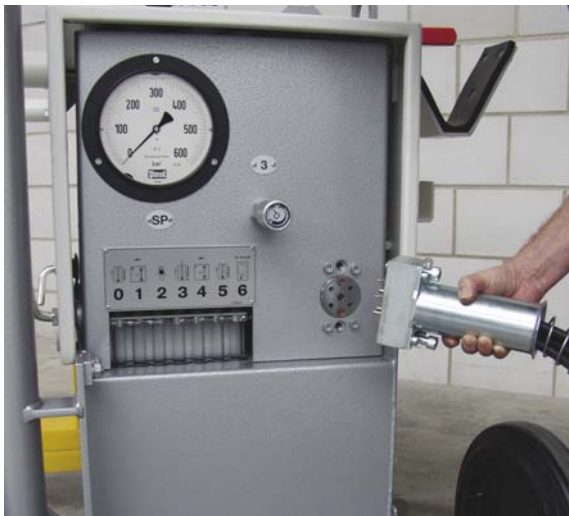
Efectuando a conexão do macaco de tensar
