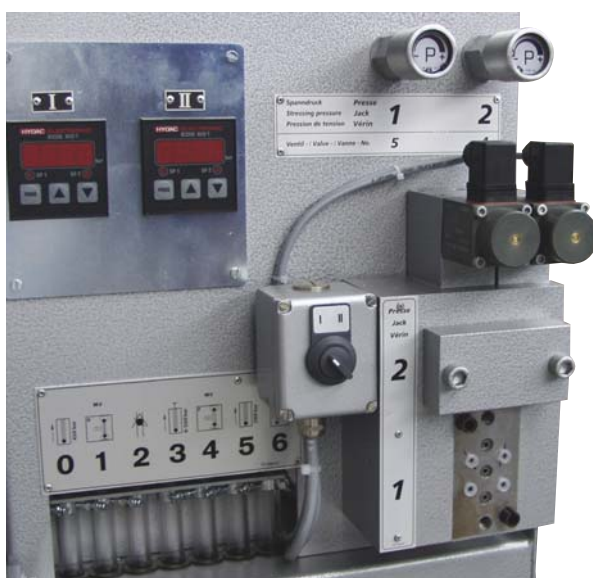
Dupla conexão (comutação de tipo eléctrico)
