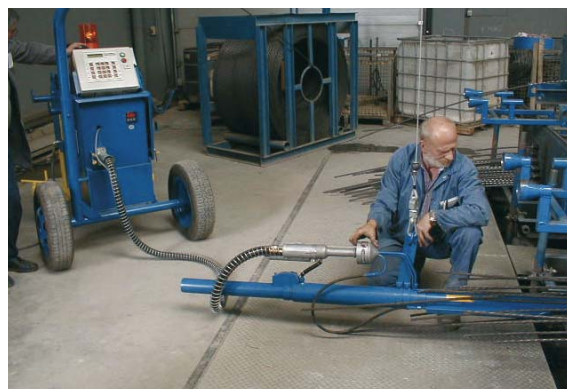
Macaco de tensar 160 kN / curso 500 mm dispendo de unidade TensaControl para o pré-esforço de cordão de 1/2"
