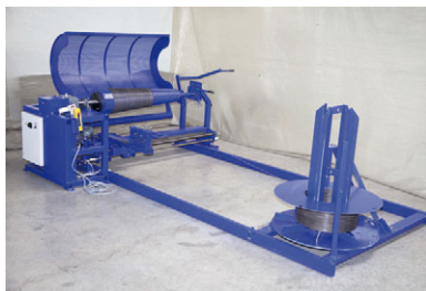
Fig. 21: Máquina bobinadeira em espiral para produção do reforço dos postes em espiral
