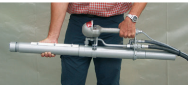
Fig. 8: tensor de 2 mangueiras 60 kN, curso 200mm
