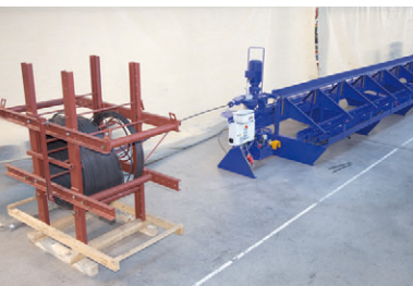
Fig. 20: Máquina de empurrar elétrica incl. mesa de 15 m
