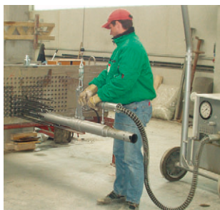
Fig. 9: tensor de 4 mangueiras 160 kN
