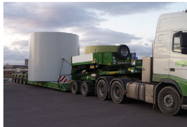
Fig. 25: Segmento de uma torre pré-moldada em trânsito
