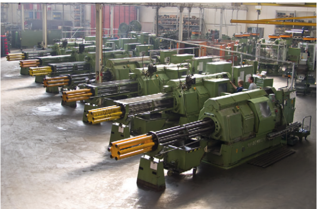
Fig. 3: Produção das cunhas em tornos automáticos
